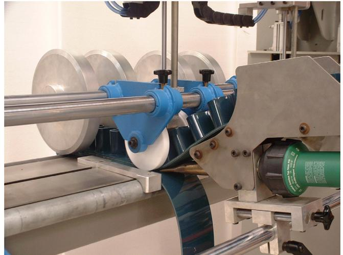
Facilidad en la regulación de los soldadores de aire caliente, ya que ésta se puede realizar en frío, gracias a las dos posiciones de estos soldadores.
